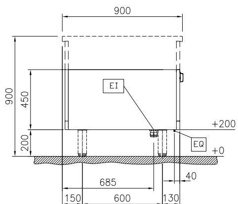
EI = Conexión eléctrica (energía)
